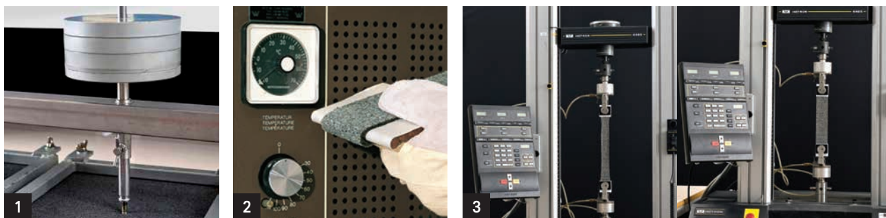
1. Punktlast 2. Köldtest 3. Test på draghållfasthet
